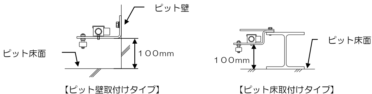
図 5-3：ピット冠水センサー
